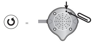
**Hinweis:** Durch ein **Reset bei Fehlfunktion** wird das Headset nicht auf die Werkseinstellungen zurückgesetzt.
